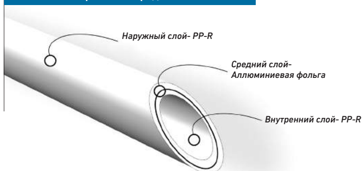
Композитная полипропиленовая труба из алюминиевой фольги посередине
