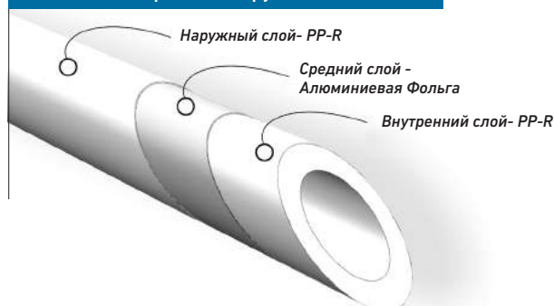
Композитная полипропиленовая труба из алюминиевой фольги снаружи
